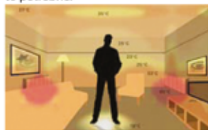
Rozloženie teplôt pri používaní tradičného vykurovacieho systému s radiátormi. Veľké rozdiely teplôt v miestnosti (18 – 65°C).
