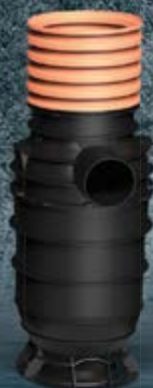
Uličná vpusť Tegra DN 315 s filtrom Súčasťou je sifón a 360° filter Objem kalového priestoru: 70 litrov Priemer odtoku: DN 160
