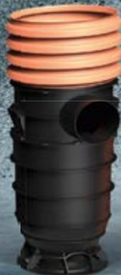
Uličná vpusť Tegra DN 425 s filtrom Súčasťou je sifón a 360° filter Objem kalového priestoru: 70 litrov Priemer odtoku: DN 200
