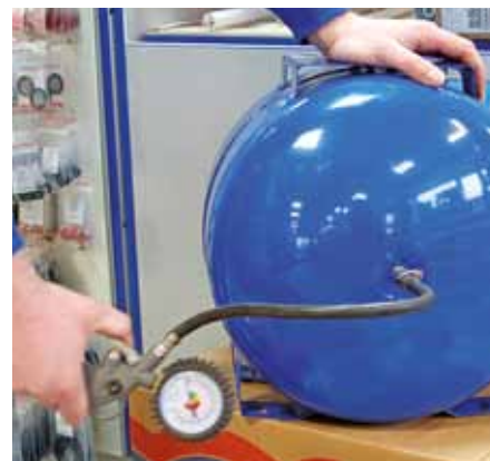
7/ Kompresorom nafúkajte vak na požadovaný tlak = o 10 % menej než je zapínací tlak na tlakovom spínači.
