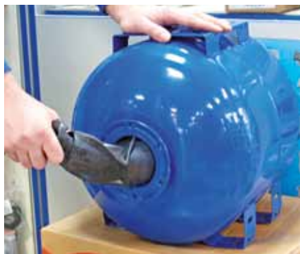
3/ Vytiahnite poškodený vak.
