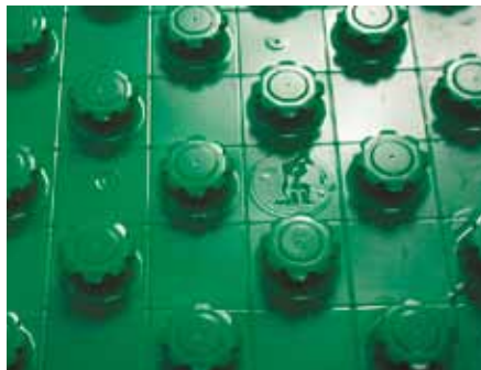
Obrázok znázorňuje detailne tvar montážneho výstupku systémovej izolačnej dosky, ktorý je v hornej časti vybavený výstupkami, ktoré znemožňujú uloženie rúrky „vybehnutie“ z polohy.
